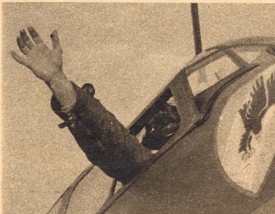
Ein Arm wird aus dem Kabinfenster gestreckt. Das heißt in der kurzen Zeichensprache der Flieger: „Latten frei! Wir lassen die Motoren an!“
